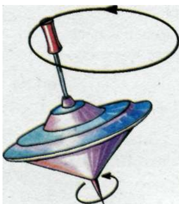
Рис. 3.5. Явление прецессии демонстрирует детская юла, вращающаяся вокруг собственной оси, в то время как ее ось описывает конус в пространстве
